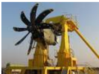
Figura 1: Il riduttore progettato e realizzato da AVIO per il nuovo motore turboelica TP400 (8 MW di potenza: qui è mostrato sul banco prova).
