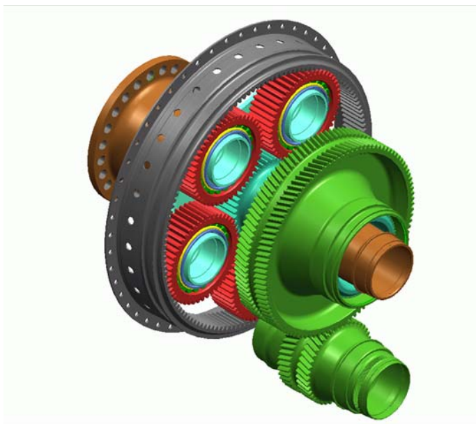
Figura 1: Il riduttore progettato e realizzato da AVIO per il nuovo motore turboelica TP400 (8 MW di potenza: qui è mostrato sul banco prova).
